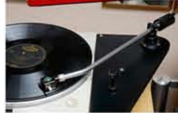
En fin gammal trotjänare, Thorens 124 från slutet av 1960-talet. Tonarm och pickup från Ortofon.
