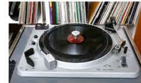
EMT 930 från 60-talet spelar även stenkakor. Startar snabbt, vilket gjorde den till Sveriges Radios standardspelare förr i tiden.
