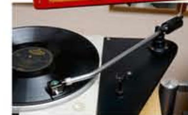
En fin gammal trotjänare, Thorens 124 från slutet av 1960-talet. Tonarm och pickup från Ortofon.
